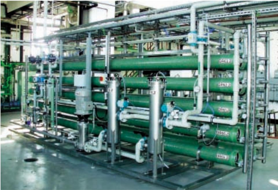
**3:** Die Spiralwickелеlemente der Umkehrosmoseeinheit halten bereits bei niedrigen Arbeitsdrücken große Mengen Salz zurück
